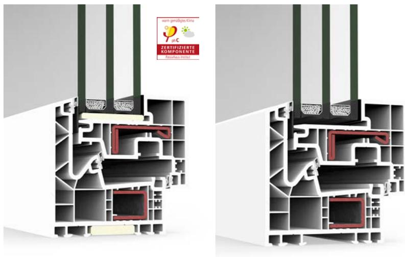
Ventana minimalista con una sección vista de tan solo 90 mm y posibilidad de nudo central reducido de la misma medida. Este sistema de 84 mm de profundidad y perfilaría de 6 cámaras combina su elegante diseño con un excelente rendimiento térmico tanto en la versión Passivhaus, certificada para la categoría warm-temperate ( $U_w$  desde  $0,71 \text{ W/m}^2\text{K}$ ), como en la versión estándar ( $U_w$  desde  $0,74 \text{ W/m}^2\text{K}$ ).
